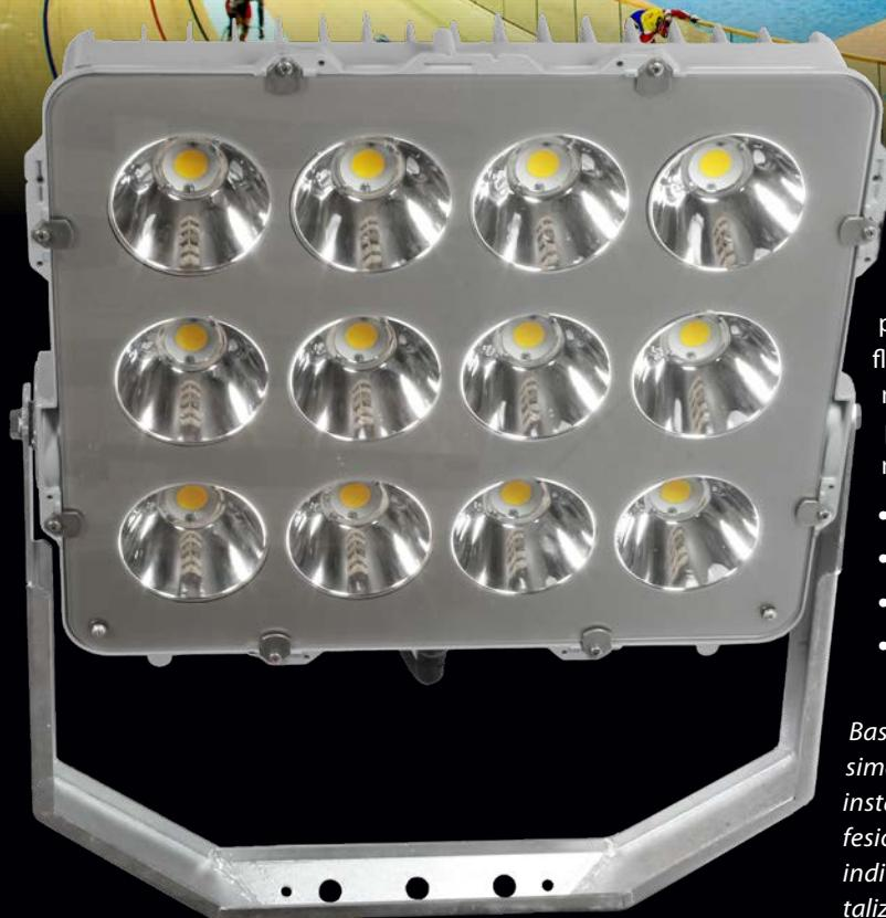
Basée sur le principe de la réflexion, l'**OPTIQUE PLUS** à faisceau symétrique offre la plus grande efficacité lumineuse pour l'éclairage d'installations sportives amateurs et de sports professionnels mineurs. Chaque LED est enveloppée dans son réflecteur unique, en aluminium de très haute pureté (99,99 %) ou métallisé sous vide avec une durabilité et une efficacité élevée, pour un meilleur contrôle de l'éblouissement (UGR et GR) et une meilleure répartition de la lumière.
